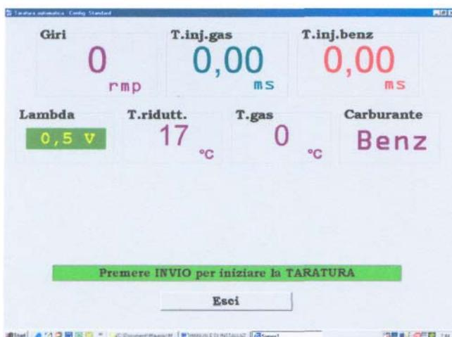
Прежде чем нажать ввод необходимо проверить все сигналы; Giri(Обор)/T.inj.gas(Вр. впр. газа)/T.inj.benz (Вр.впр.бенз.)/T.ridutt.(Темп. Редукт.)/ T.gas(Темп.газа). Они должны считываться. **Важно: Температура редуктора ниже 50°C не позволяет системе осуществить калибрацию.** Установите обороты двигателя на 3000 об\мин и нажмите ВВОД, не изменяйте положение педали до окончания процедуры настройки.
